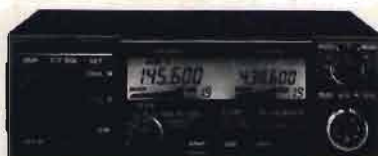
IC 2400 ICOM Transceiver doppio VHF/UHF
