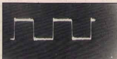
Onda da 1,5 MHz su carico di 100 ohm.
