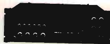
ICOM IC 781 ricetrasmittitore multimodo HF, 150 W pep
